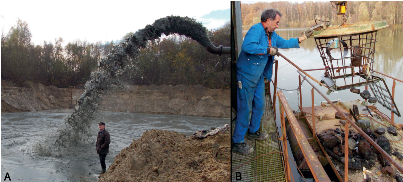
Abb. 4: A Spülfeld der Sandgrube Greven-Bockholt, aus dem kleinere Teile des Mammutschädels geborgen wurden. B Entleerung des Fangkorbs auf einem Schwimmbagger.
