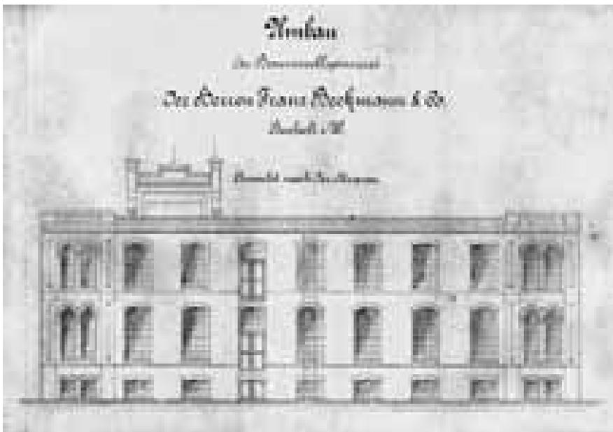
*Plan zum reduzierten Wiederaufbau der Spinnerie Franz Beckmann, Fassadenansicht nach Abnahme des dritten Obergeschosses*
