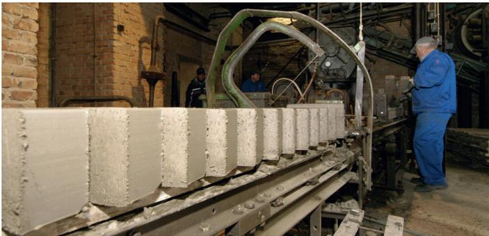
Während der Dieselmotor gleichmäßig tuckert und die Räder des Kollergangs unter ohrenbetäubendem Krach ihre Runden drehen, produziert die Strangpresse stündlich mehrere hundert Ziegel. Von 10 – 11 Uhr Lorentransport, von 11 – 13 Uhr Ziegelproduktion, von 14 – 15 Uhr Lorentransport, von 15 – 17 Uhr Ziegelproduktion.
