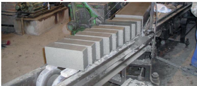
Während der Dieselmotor gleichmäßig tuckert und die Räder des Kollergangs unter ohrenbetäubendem Krach ihre Runden drehen, produziert die Strangpresse stündlich mehrere hundert Ziegel.
