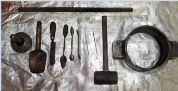
Formwerkzeug: Abzugschiene (oben), Stampfer aus Metall u. Holz, Truffel, Lanzetten, Hammer, Formkasten (von li. nach re.) © Michael Braun
