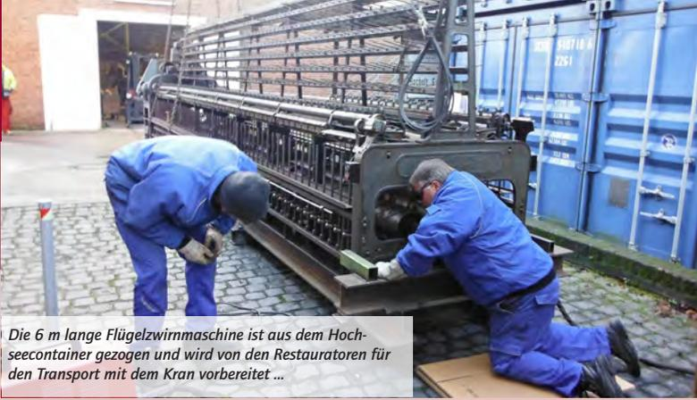
Die 6 m lange Flügelzwirnmachine ist aus dem Hochseecontainer gezogen und wird von den Restauratoren für den Transport mit dem Kran vorbereitet ...
