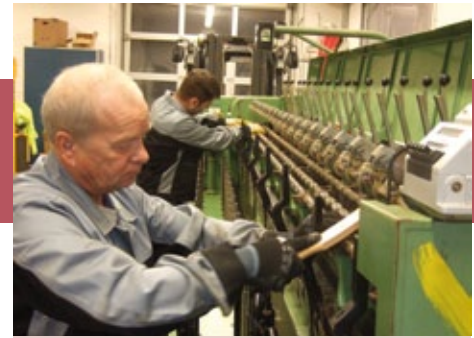
Restaurieren des Baumwollflyers von 1960 durch Mitarbeiter der Firma Techno-System aus Nordhorn
