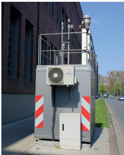
**Abb. 1:** Messstation zur dauerhaften Erfassung der Feinstaub-Emissionen
