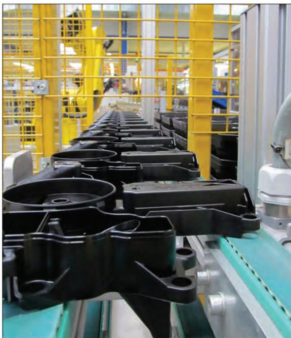
Abb. 3: Hengst Automotive – Fertigung von Ölnebelabscheidern am Standort Nordwalde (Foto: Hengst SE & Co. KG)
