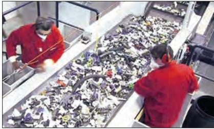
Abb. 2: REMONDIS Lippewerk, Recycling von Elektroschrott (Foto: REMONDIS AG)
