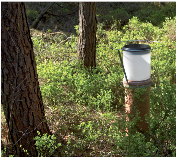
Abb. 1: Waldmessstation mit offenem Regensammler (Foto: J. LETHMATE)
