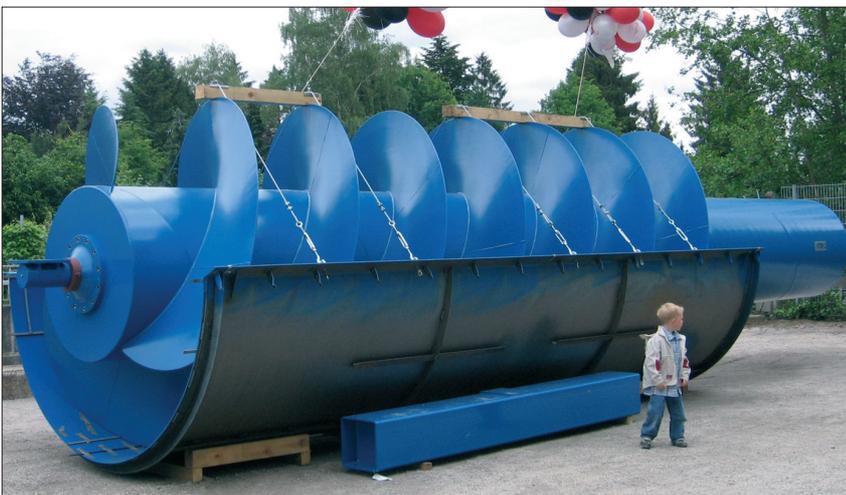
Abb. 3: Wasserkraftschnecke Rhede-Krechting (Foto: S. PROTT)
