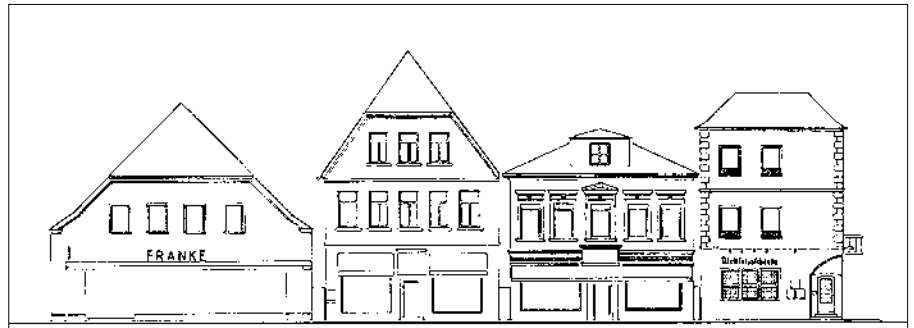
Die großflächigen Schaufenster im Erdgeschoß der alten Häuser haben deren architektonischen Aufbau zerstört.
