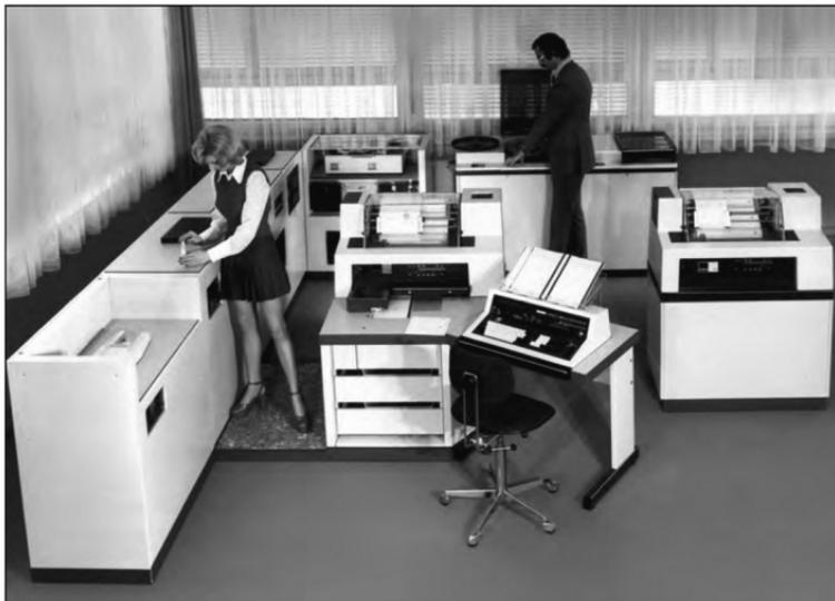
*Abb. 6: Ein Kienzle-Erfolgsrechner der Klasse 6000 mit verschiedenen Peripheriegeräten*
