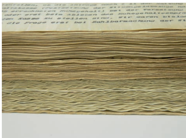
Nach der Entsäuerung im Einzelblattverfahren zeigt sich in Abhängigkeit von der Papierbeschaffenheit eine unterschiedliche Welligkeit innerhalb einer Akte.
