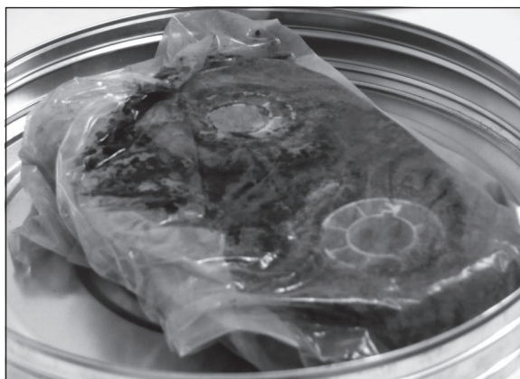
Diese Nitratfilmrollen sind zerfallen. Die Verpackung sollte nicht gedankenlos entfernt werden, denn die austretenden Dämpfe sind giftig.
