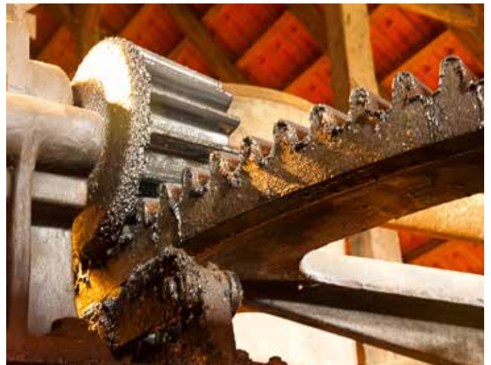
Zahnrad des Kollergangs in der Maschinenziegelei.
