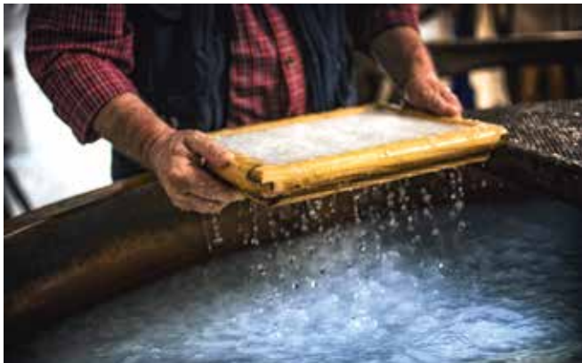
Mit dem Sieb wird Papier aus der Bütte handgeschöpft.
