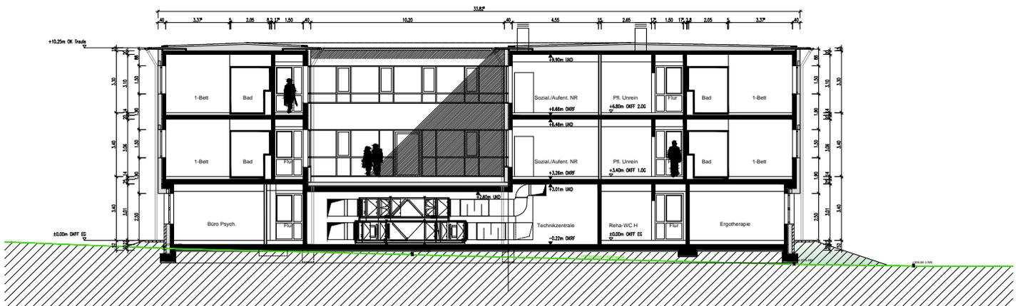
Schnitt E-E durch die Technikzentrale, den zweigeschossigen Atriumhof und Innenansicht Nord
