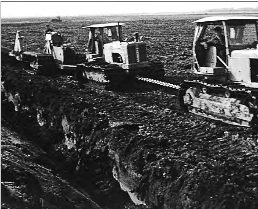
Bis zu fünf Raupenschlepper ziehen Ende der 1950er Jahre den Pflug, mit dem der Boden bis zu 1,60 m Tiefe aufgerissen und Sand- sowie Torfschichten miteinander vermischt werden.
