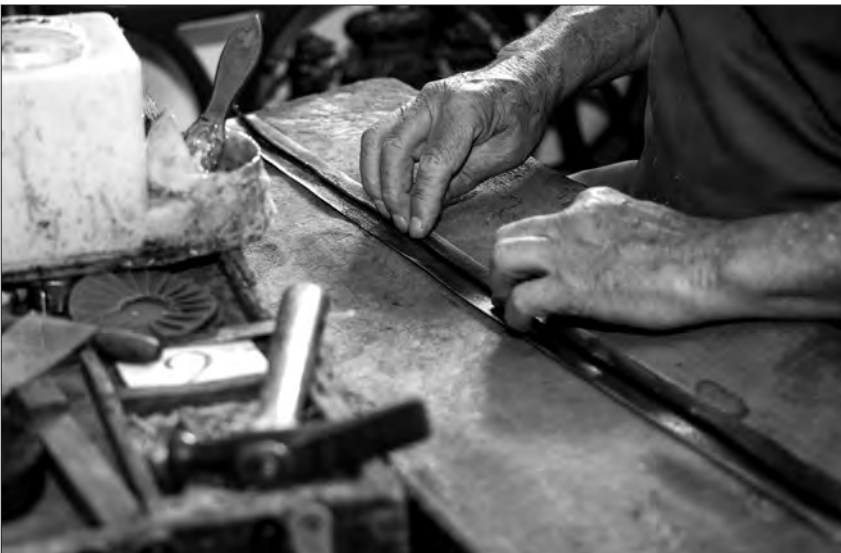
Als Verbindung des Schaftes und der Sohle wird für den Maßschuh ein Zierband erstellt.
