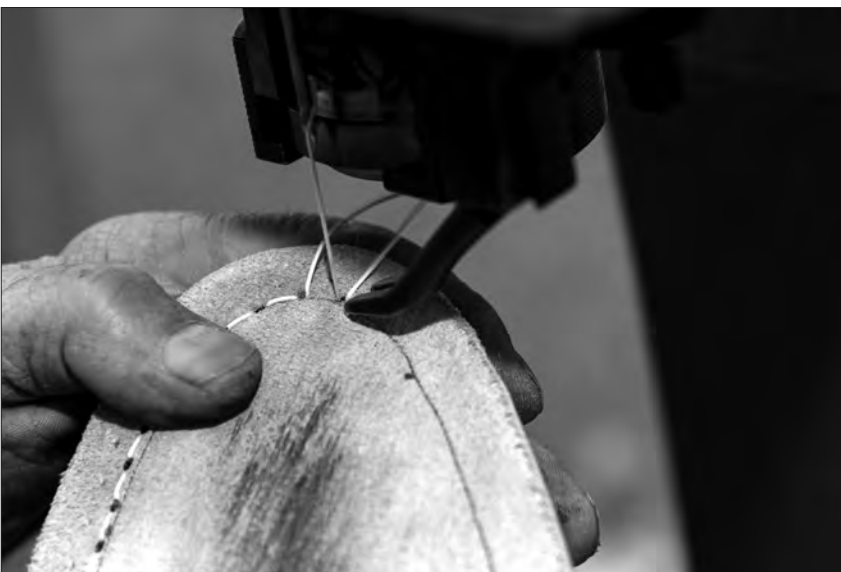
Mit einer speziellen Nähmaschine werden die einzelnen Schichten der Sohle verbunden.
