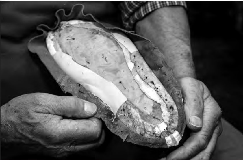
Der innere Aufbau eines Schuhs von unten. Noch ist der Schaft mit dem Leisten verbunden.
