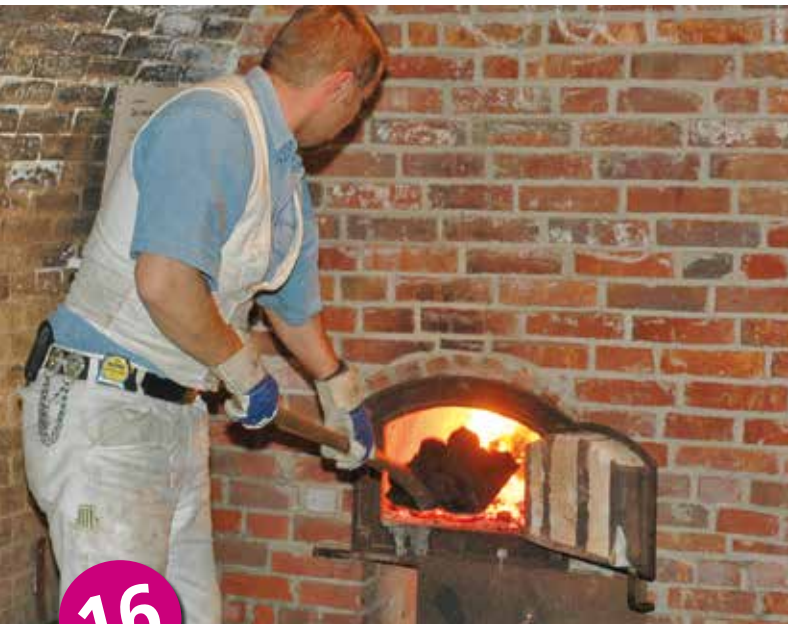
Der Brenner befüllt den Ringofen mit Kohle.
