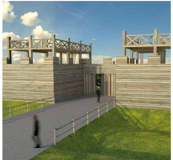
Das Westtor mit einem Teil der Holz-Erde-Mauer wird im Römerpark Aliso rekonstruiert.
