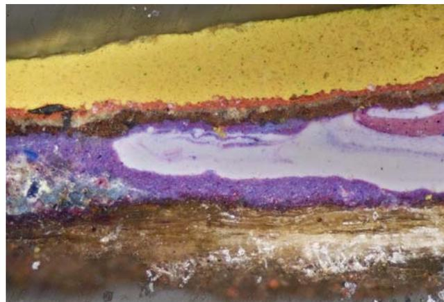
8 Werther, Böckstiegelhaus (1826), Querschliff der verschiedenen Farbfassungen von einem der Ständer des Vordaches von 1944/45. Foto 2014.
