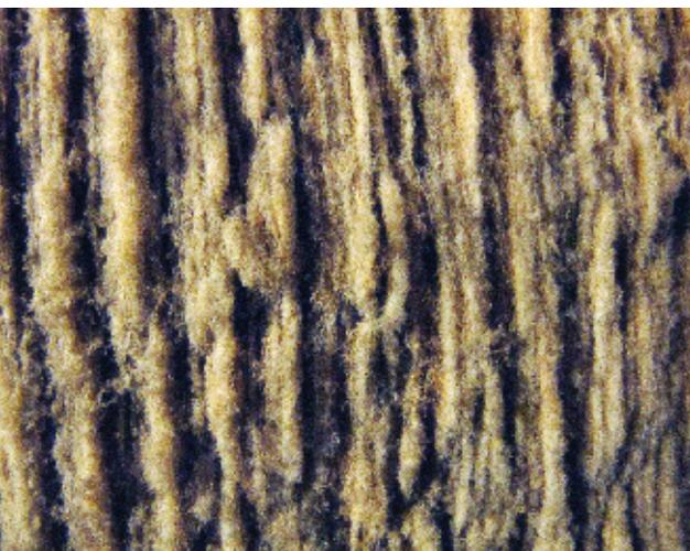
4 Holzoberfläche mit Korrosionsschicht, Makroauf-
