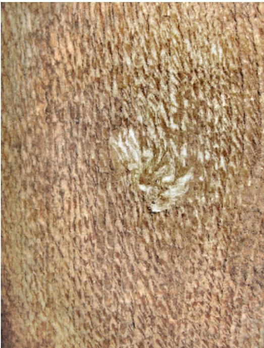
3 Holzoberfläche mit Korrosionsschicht, durch Probe-
