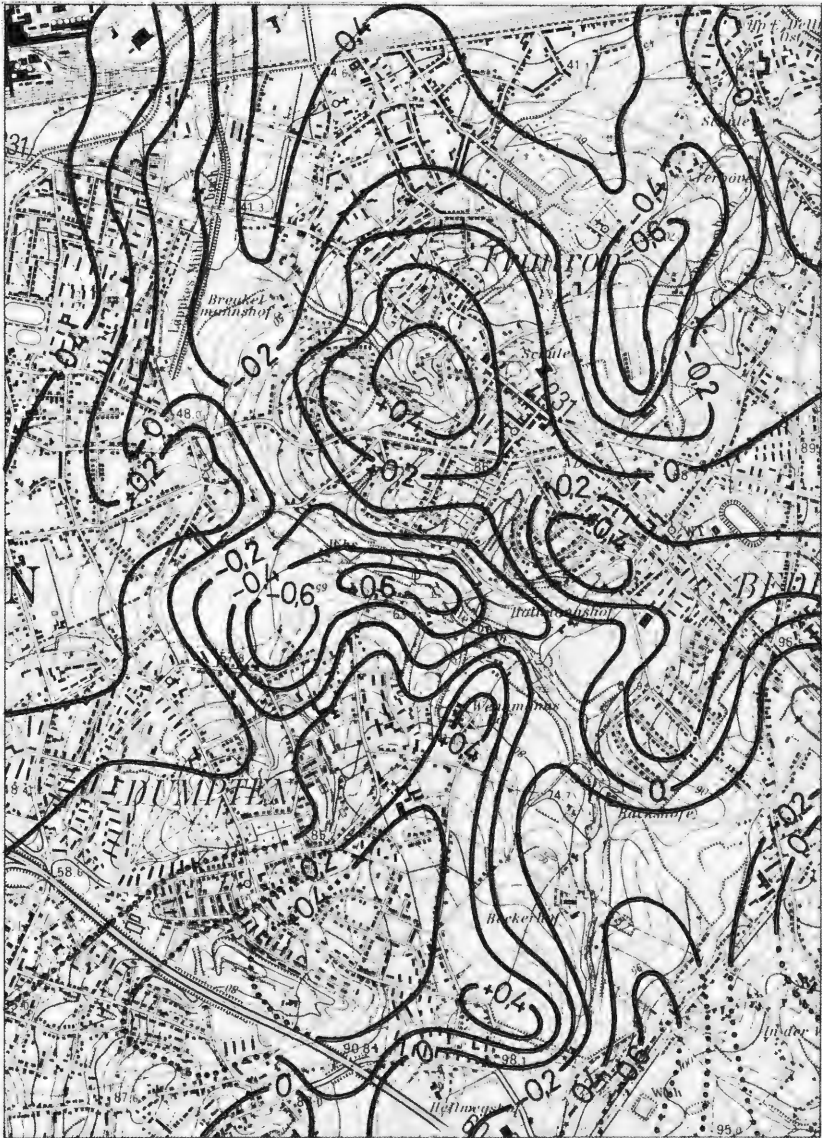
Abb. 6 Abweichung der Temperaturverteilung vom Mittelwert ( 28,8^{\circ}\text{C} ) an einem Strahlungstag (12.20 Uhr).
