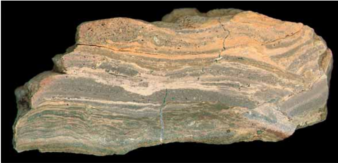
Abb. 10: Feinlaminierte Wechselschichtung aus Schluffstein (hell) und karbonatischem Feinsandstein, schwach glaukonitisch, Lagen z.T. gradiert, zerbrochen und verstellt (Anschliff), Lesestein vom Spaltenbereich A und B
