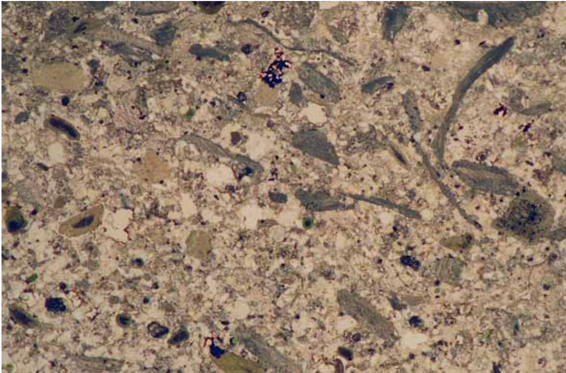
Abb. 6: Karbonatischer Feinsandstein mit Bioklasten (Dünnschliff 5900), Spalte A im Steinbruch Düstertal, R 34 79 200, H 57 03 650, Blatt 4518 Madfeld
