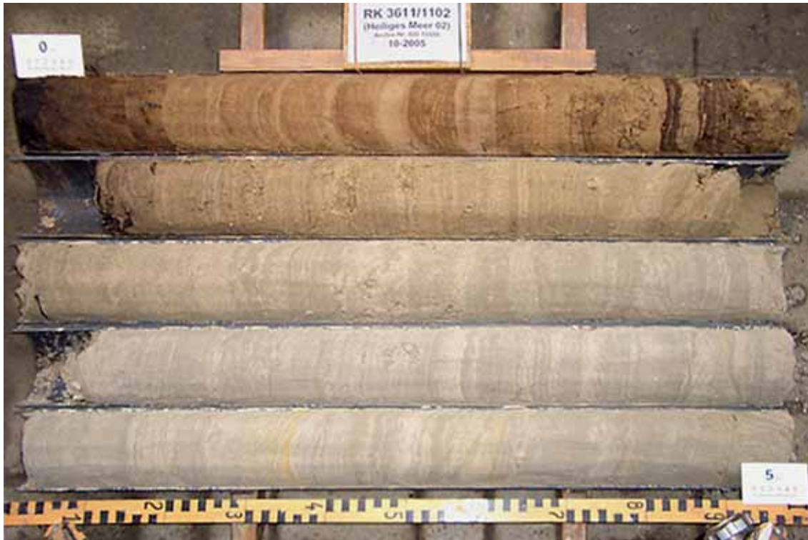
Abb. 20: Ablagerungen des Talsands in der Rammkernbohrung 3611/1102 (Teufenintervall: 0 m – 5 m u. GOK).
