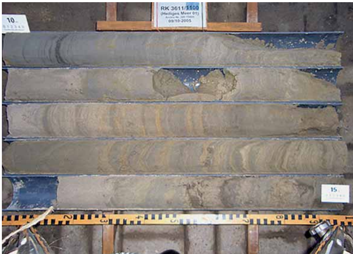
Abb. 19: Sedimente der Schluff- und Sand-Schluff-Wechselfolge in der Rammkernbohrung 3611/1100 (Teufenintervall: 10 m – 15 m u. GOK).
