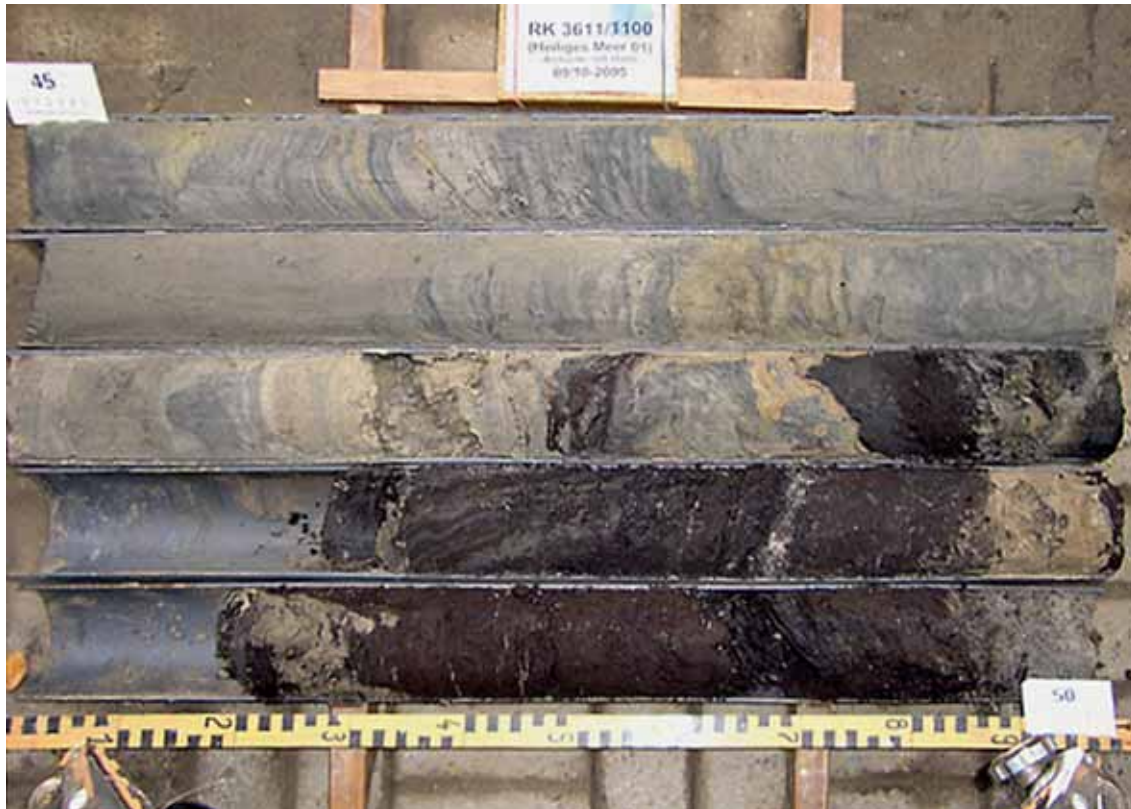
Abb. 13: Holsteinzeitliche Torfe in der Rammkernbohrung 3611/1100 (Teufenintervall: 45 m – 50 m u. GOK).
