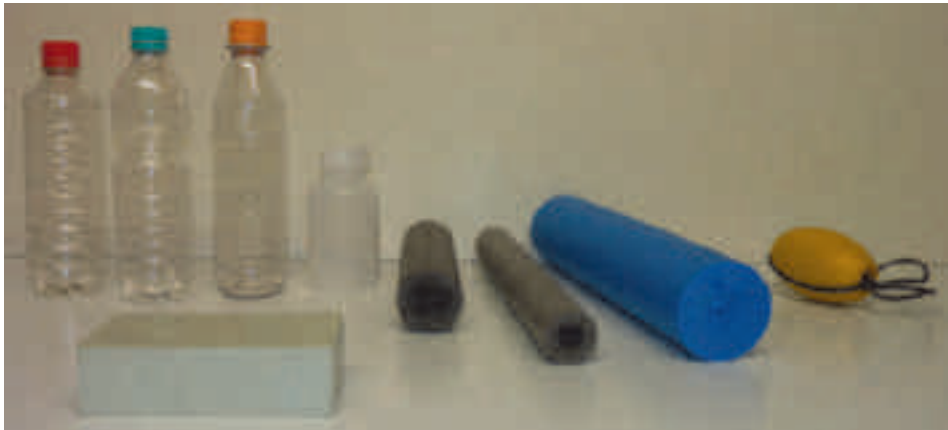
Abb. 19: Verschiedene Schwimmhilfen zur Einlage in Wasserfallen oder zur äußeren Befestigung an den Fallen. Von links nach rechts: 0,5-Liter PET-Trinkflaschen, kleine PET-Flasche aus dem Laborbedarf, Styroporstück, PE-Dämmschlauchmaterial zur Rohrisolierung, Teilstücke aus Kinder-Schwimmhilfen („Schwimmnudeln“), Markierungs-Schwimmer. Foto: A. Kronshage
