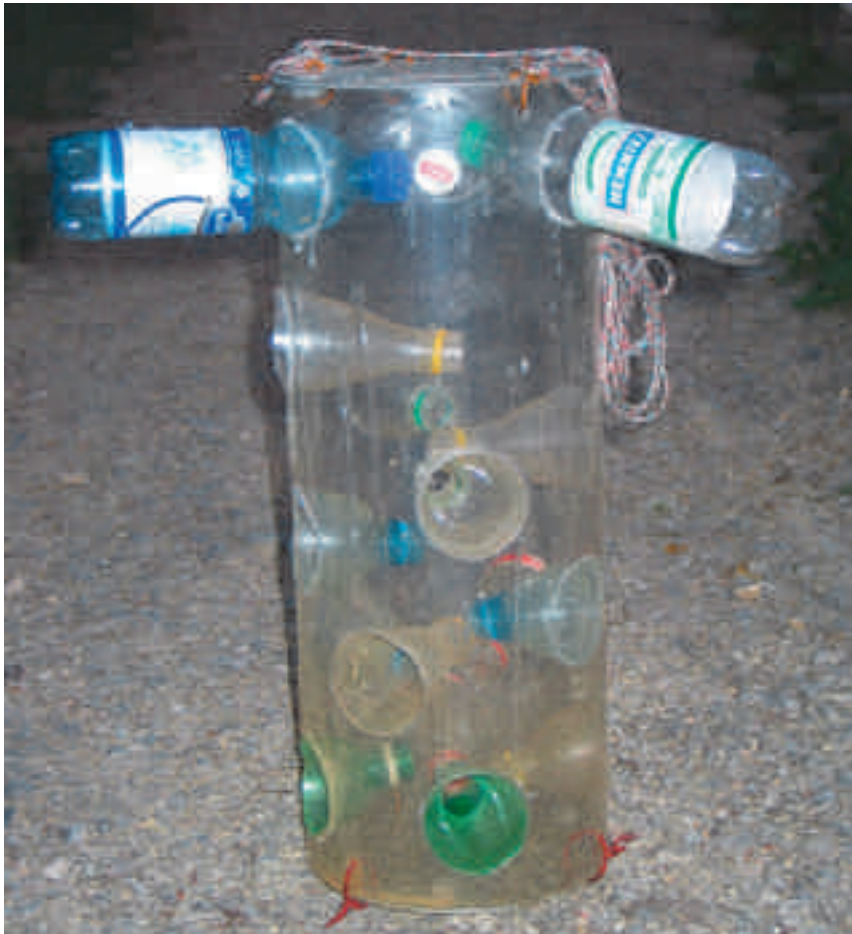
Abb. 5: Röhrenfalle aus Acrylglas. Foto: S. Zumbach
