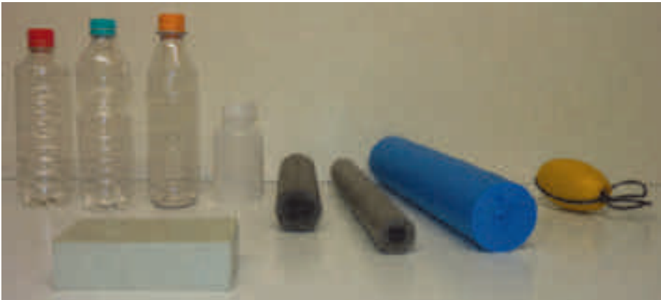
Abb. 19: Verschiedene Schwimmhilfen zur Einlage in Wasserfällen oder zur äußeren Befestigung an den Fallen. Von links nach rechts: 0,5-Liter PET-Trinkflaschen, kleine PET-Flasche aus dem Laborbedarf, Styroporstück, PE-Dämmschlauchmaterial zur Rohrisolierung, Teilstücke aus Kinder-Schwimmhilfen („Schwimmnudeln“), Markierungs-Schwimmer. Foto: A. Kronshage
