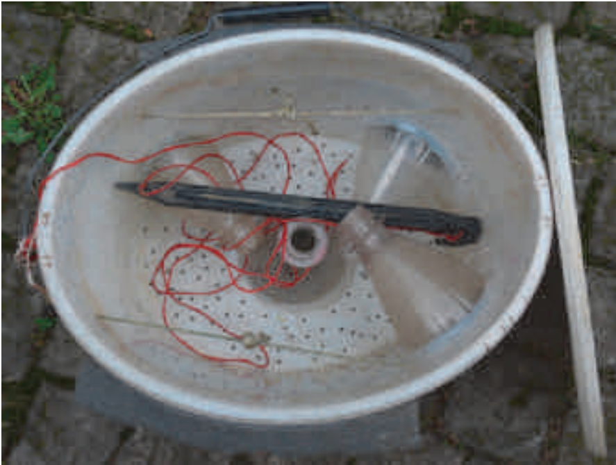
Abb. 9: Blick in eine Falle aus einem handelsüblichen 15-L-Mischeimer für Farben mit vier Reusenöffnungen aus Flaschenköpfen mit Heißkleber verklebt (zusätzlich mit Blumendraht oder Kabelbinder befestigt). Der Boden und die Seitenwände sind perforiert, ebenso der Deckel. Schwimmer – hier aus Rohrisolierung – sind seitlich mittels Maurerschnur befestigt. Statt Schaumstoffröhren sollten besser kleine luftgefüllte Plastikflaschen als Schwimmer verwendet werden. Damit die schwimmenden Eimer nicht abtreiben, werden sie mittels Maurerschnur an einem Hering (am besten aus Hartkunststoff) im flachen Wasser befestigt. Foto: M. Schlüpmann.
