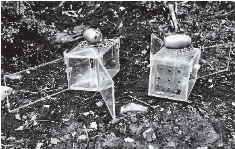
Abb. 4: Plexiglasfalle von DOLMEN (1983), links in der Ansicht von vorne mit Blick in den Fangtrichter, rechts Rückansicht mit Bohrungen, die den Wasseraustausch erleichtern sollen. Foto: P. E. FREDRIKSEN/J. O. SOLEM.
