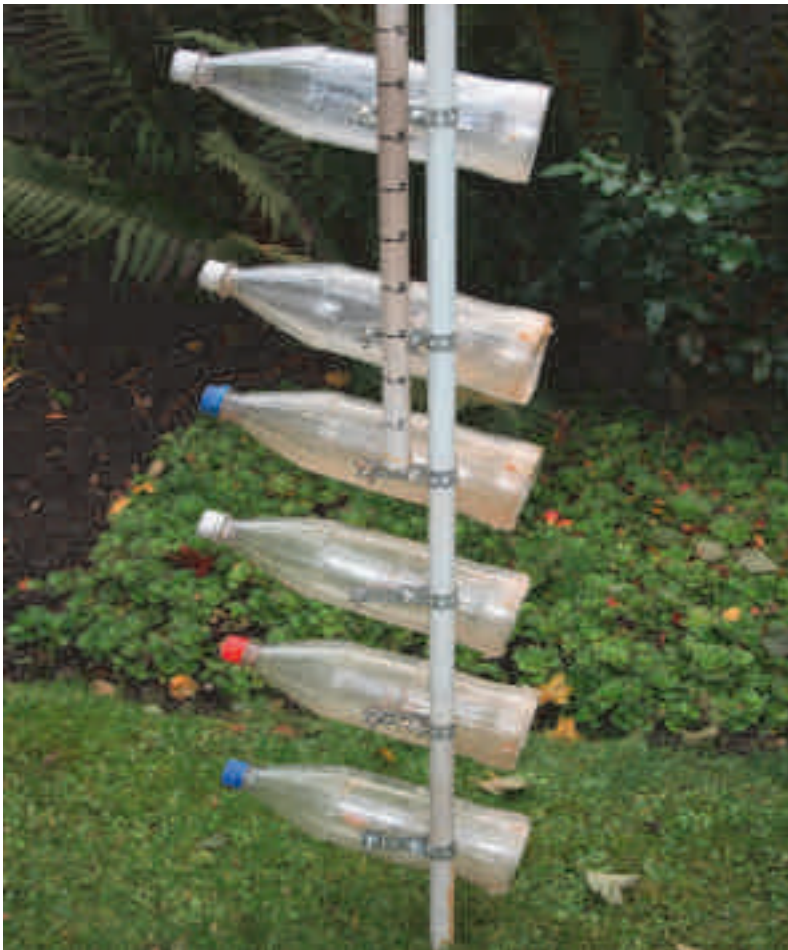
Abb. 7: Reusenfallen-Konstruktion für die tieferen Standorte im Gewässer mit sechs Flaschenreusen. Die Anzahl der eingesetzten Flaschenreusen variiert mit der Wassertiefe. Die oberste Reuse wurde immer an der Wasseroberfläche befestigt. Mit dem „Messstab“, der oben zu sehen ist, werden die Abstände der Flaschenreusen passend eingemessen. Foto: J. Bliesener.
