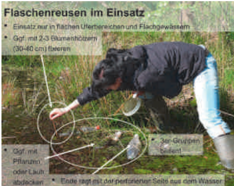
Abb. 3: „Betriebsanleitung“: Auslegen von Flaschenreusen am Ufer mit den wichtigsten Anweisungen für einen sicheren Einsatz. Foto: M. Schlüpmann.
