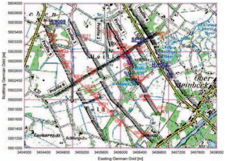
Abb. 2: Lage der Sondierungspunkte: Rote Kreuze = VES; Schwarze Punkte = RMT; Blaue Kreuze = HLEM; Blaue Kreuze im Kreis: Bohrungen
