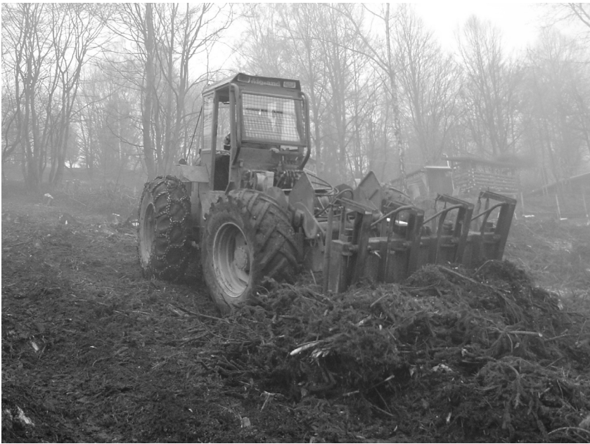
Abb. 12: Astwerk wird mit einem Räumfix zusammengesoben (Foto: Robert Trappmann).
