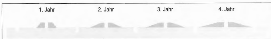
Abb. 19: Schrittweise Entstehung eines Rieselrückens: „Natürlicher Rückenbau“.
