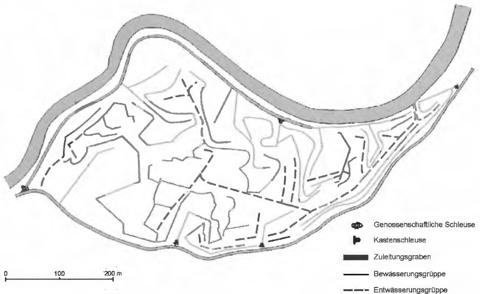
Abb. 14: Bewässerungsanlage mit Wilder Berieselung in einer genossenschaftlichen Anlage bei Ostrittum an der Hunte, verändert nach HETZEL (1957).
