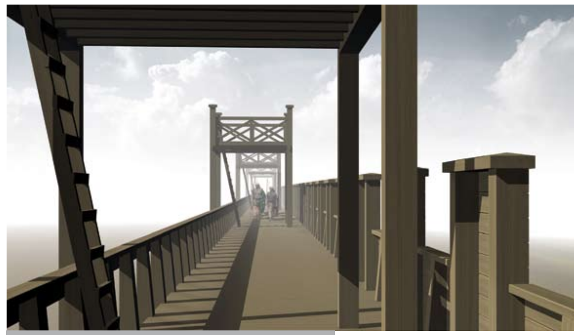
Abb. 50: Bergkamen-Oberaden. Computerstil der rekonstruierten Holz-Erde-Mauer des Römerlagers Oberaden. Der Blick schweift den Wehrgang entlang. Rechts ist die Brustwehr mit den Zinnen erkennbar. In regelmäßigen Abständen sind die Zwischentürme errichtet, deren obere Plattform über eine Leiter zu erreichen war. Bild: Pansa BV, Nijmegen/K. Peterse.
