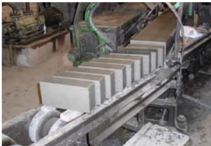
Während der Dieselmotor gleichmäßig tuckert und die Räder des Kollergangs unter ohrenbetäubendem Krach ihre Runden drehen, produziert die Strangpresse stündlich mehrere hundert Ziegel. 10 – 11 Uhr Lorentransport, 11 – 13 Uhr Ziegelproduktion, 14 – 15 Uhr Lorentransport, 15 – 17 Uhr Ziegelproduktion
