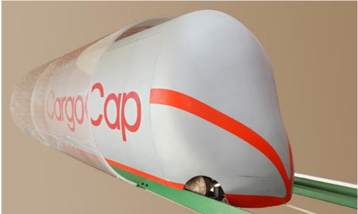
Abb. 21: Modell einer Transportkapsel (Cap) im Maßstab 1:2 // um 2000
