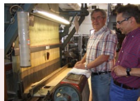
Horst Lommel und Rolf Wendemuth passieren die Fäden am reparierten Riet des Plüschstuhles, das jedoch so schadhaft war, dass es komplett getauscht werden musste.
