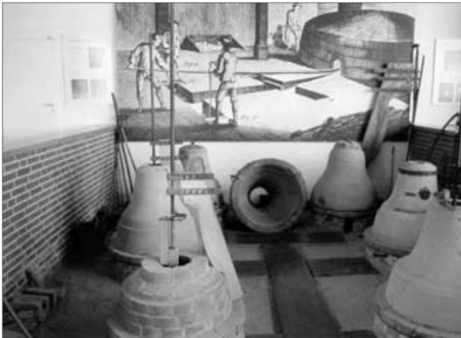
Glockengrube mit Lehmformen
