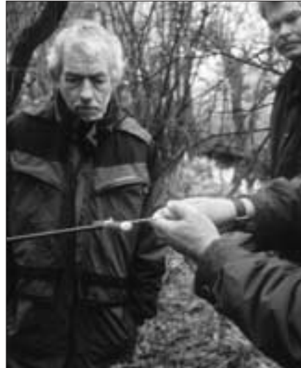
Festigkeitsprüfung mit dem Handbohrer
