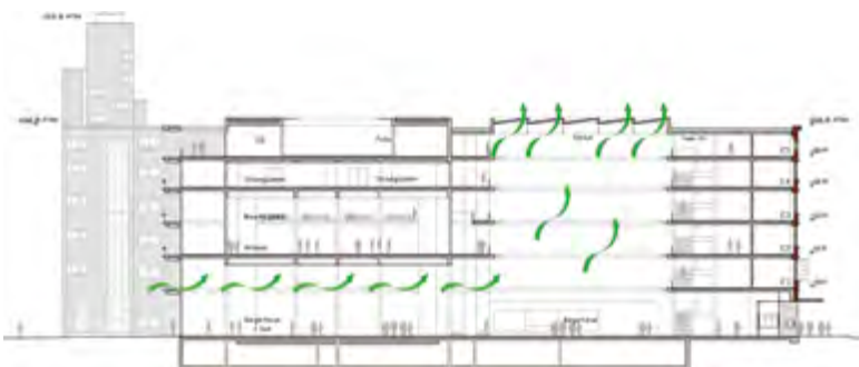
Belüftung Atrium. Be- und Entlüftung über Fensteröffnungen in der Westfassade sowie im Dach des Atriums
