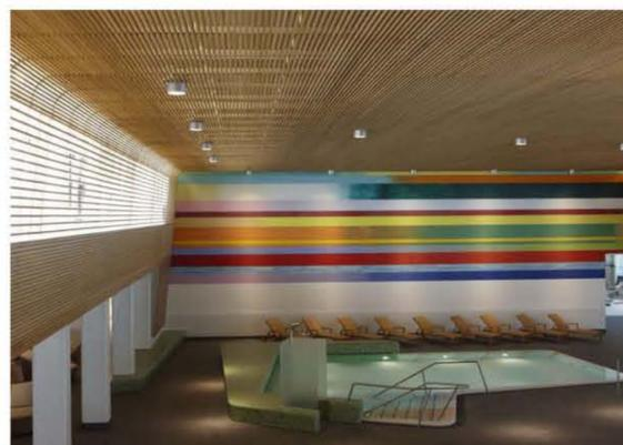
Lamellenstruktur für eine geborgene und intime Atmosphäre, ohne den Blick auf die Badehalle zu versperren. Zugleich dient sie als Schalldämpfer, um die Geräusche aus der Badehalle weitgehend zu reduzieren.
