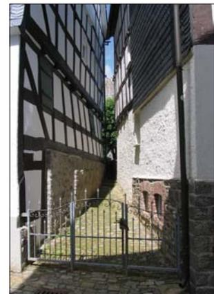
**468+469** Den Abschluss einer Einfriedung als Laubhecke oder als Gitter kann ein gemauerter Pfeiler bilden an den ein Torflügel angeschlägt. Dieser wird zweckmäßigerweise aus Metall erstellt, allein wegen der Haltbarkeit und wegen des zu erwartenden Umgangs. Das kräftige Zuschlagen – ob aus Absicht oder aus Versehen – muss ein Tor schon manches Mal aushalten müssen. Es gestattet auch den Einblick, aber auch den Ausblick auf die Dinge, die da kommen.
