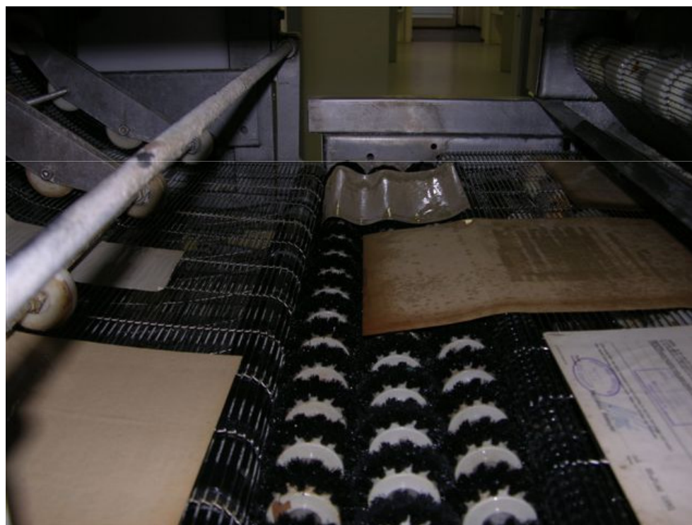
Blick in eine Entsäuerungsanlage für das Einzelblattverfahren der Firma GSK
