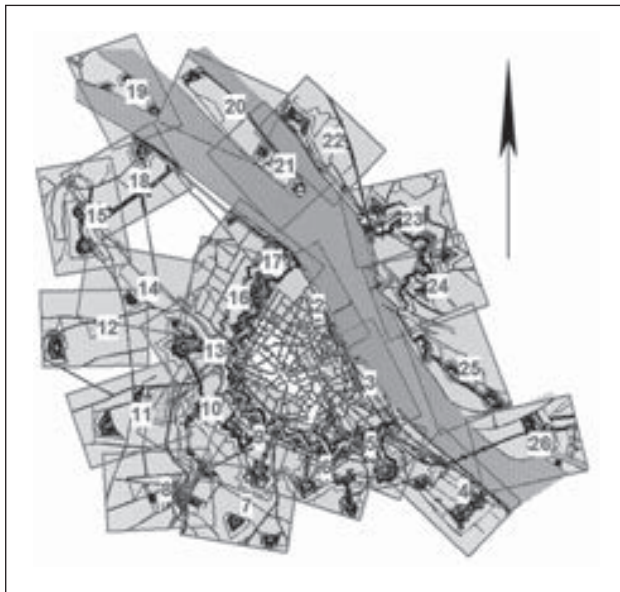
Abb. 4: Lagerichtige Darstellung der 26 Kartenblätter, die als Vorlage für den digitalen und georeferenzierten Mainzer Festungsplan von 1866 verwendet wurden
