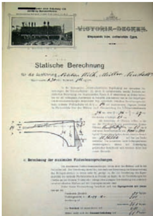
Abb. 2: Statische Berechnung einer Victoria-Decke mit 4,3 m Spannweite, um 1908 (Bauakten Neustadt an der Weinstraße)
