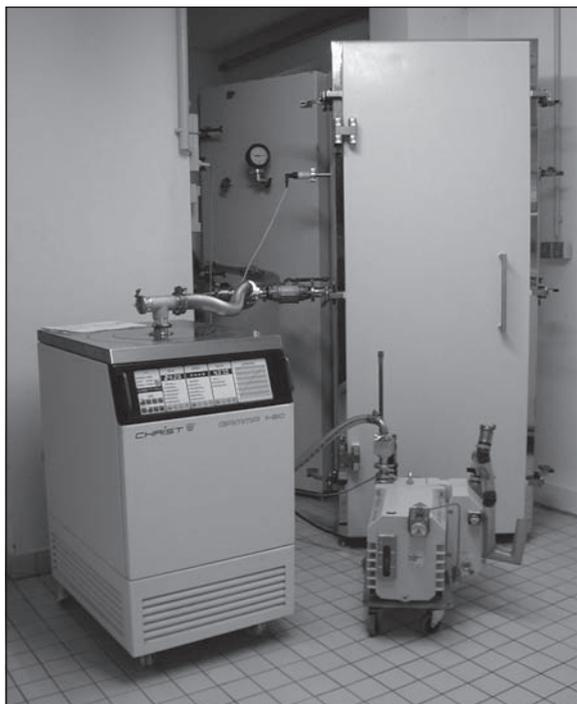
Abb 3: Gefrier Trocknungsanlage im LWL-Archivamt – links im Bild der Eiskondensator, im Vordergrund befindet sich die Vakuumpumpe, rechts im Hintergrund einer der drei Trockenschränke
