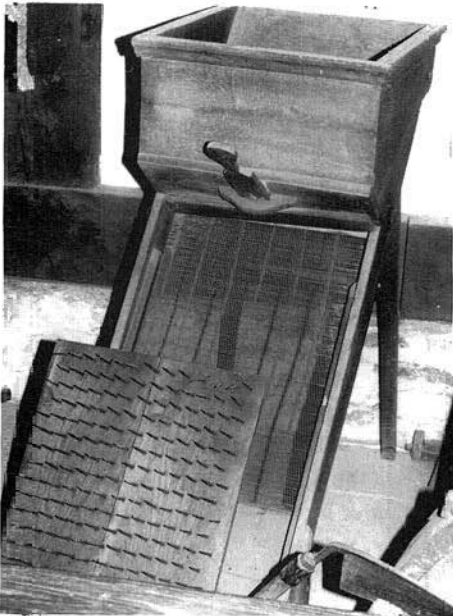
Abb. 66. Standsieb (Kornharfe) aus dem Lippischen Raum (Ostwestfalen). Höhe 140 cm, Trichter 66 x 62 cm. - Bei Gebrauch wird das Nagelbrett über das schrägstehende Sieb gelegt.
