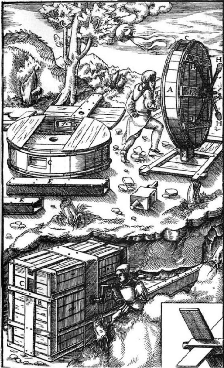
Abb. 67. Windmaschinen aus dem sächsischen Bergbau (Mitte des 16. Jhs.). Bei den dargestellten Objekten fehlt die für die Funktionsfähigkeit eines Zentrifugalgebläses notwendige Ansaugöffnung in der Nähe der Achsenwelle.
