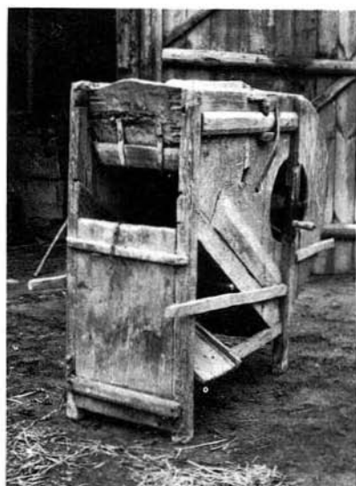
Abb. 28. Fränkische Windfege ( Putzmühle ) aus der Umgebung von Schwabach (Mittelfranken). Deutlich ist das vertikal eingelassene Trennbrett zwischen den beiden Standpfosten am Auswurfende zu erkennen. Der Boden des Trichters öffnet sich nicht – wie bei den meisten süddeutschen Geräten – zum Auswurfende hin, sondern zur Gebläse- bzw. Windradseite. Das Gerät stammt möglicherweise aus der ersten Hälfte des 19. Jhs.
