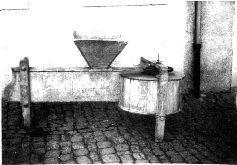
Abb. 52. Gußeisernes Zahnradgetriebe an einer gestreckten Windfège mit horizontalem Wind- oder Flügelrad aus der Eifel. Das eiserne Zahnradpaar dürfte nachträglich anstelle des hölzernen Kammrades eingebaut worden sein. – Wahrscheinlich wurde das Getriebe mit der eisernen Kurbel über eine von Hand betätigte Schubstange bewegt.
