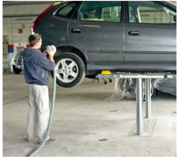
Reparatur eines Fahrzeugs und Einsatz der Unterflur-Hebebühne
