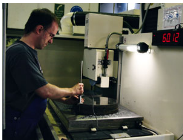
Jens Giese setzt seinen Messschieber auf das Werkstück und liest den aktuellen Wert auf einem großen Display ab
