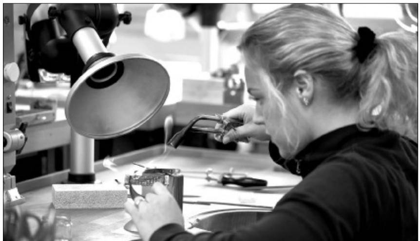
Eine auszubildende Goldschmiedin erhitzt ein Werkstück mit einem Goldlötbrenner. Entstehende Gase werden abgesogen.
