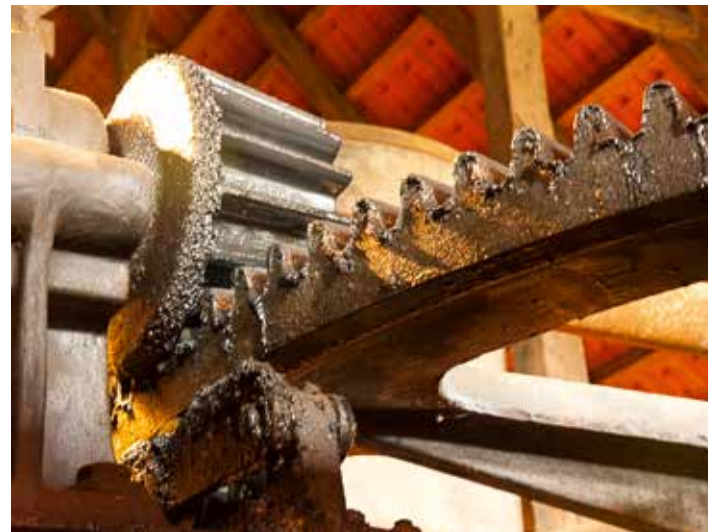
Zahnrad des Kollergangs in der Maschinenziegelei.
