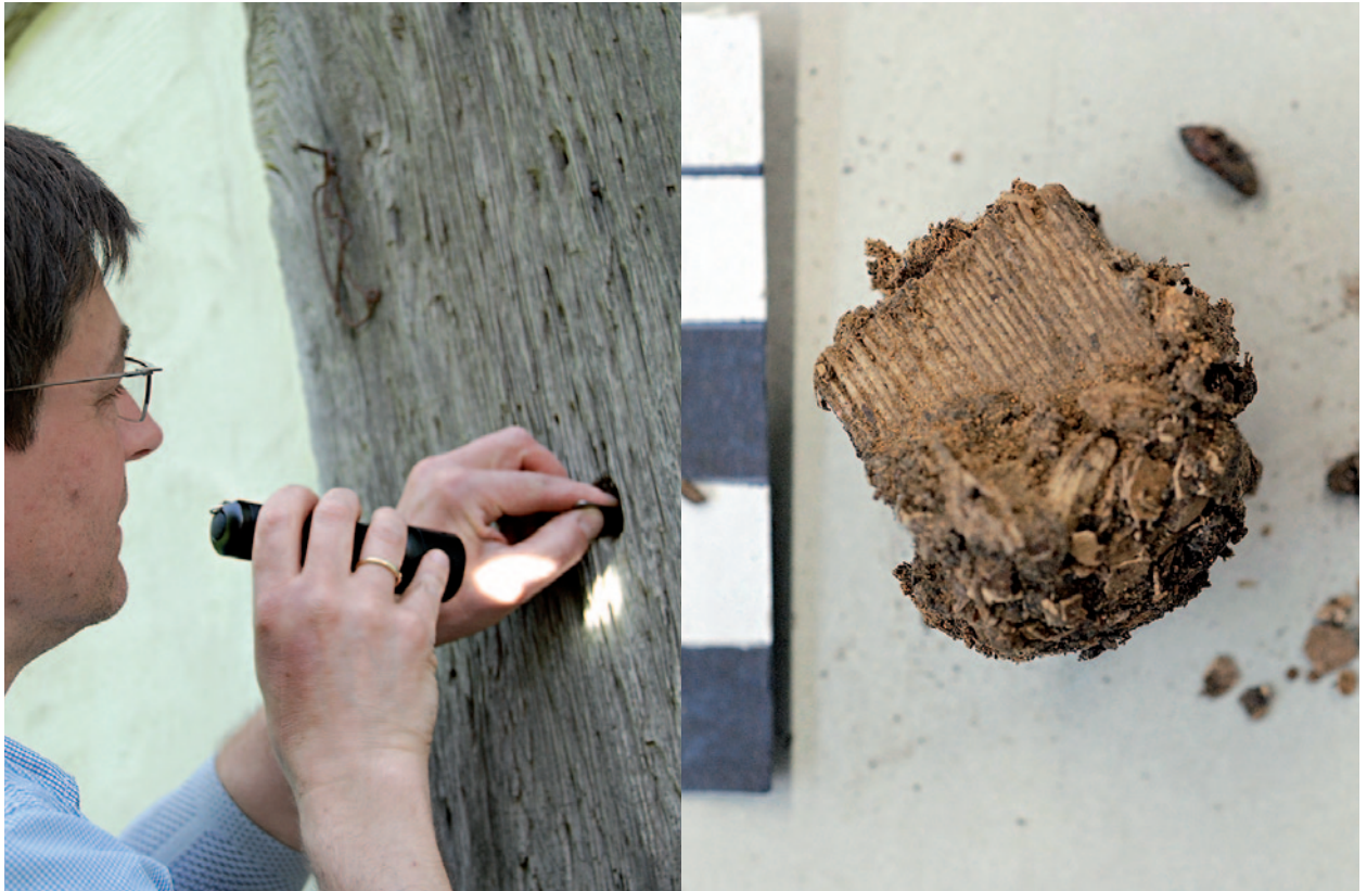
Holzrestaurator Wolfram Bangen untersucht ein Bohrloch. In Bohrloch Nr. 23 in der Leibzucht des Lippischen Meierhofes fand sich ein Holzstück mit anhaftenden Eierschalenresten.
