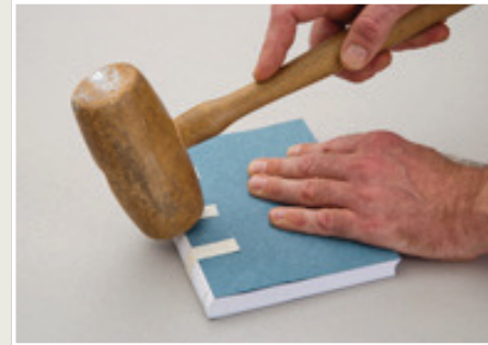
Schritt 4: Buchrücken runden & abpressen
